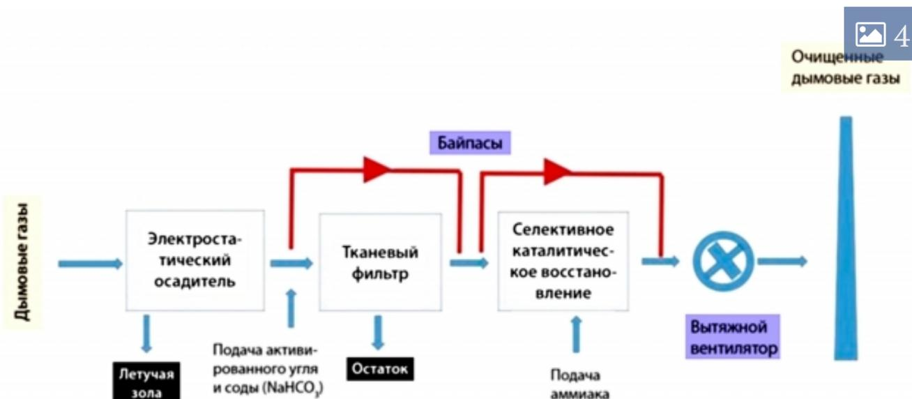
Рис. 4. Схема очистки дымовых газов на МСЗ в Харлингене
